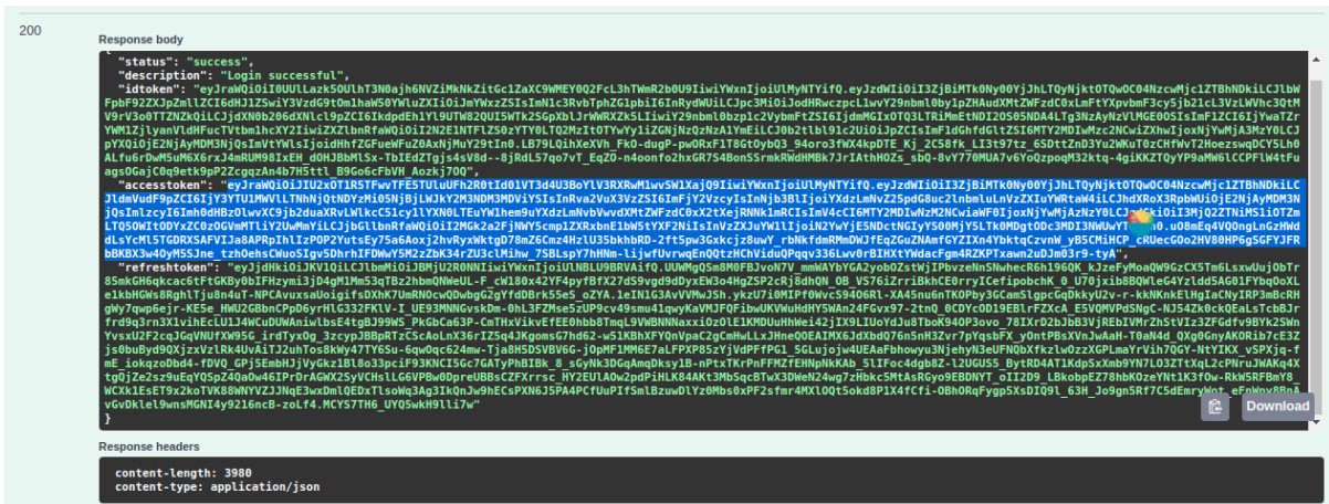
Fig. 7: REST API Login Accesstoken
