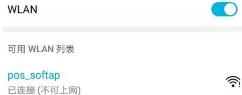
图 1: 连接 ESP32 AP
