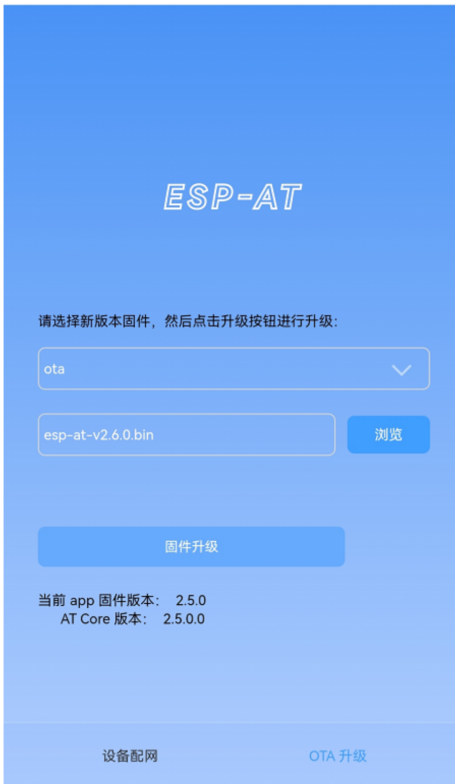
图 8: 选择待发送的新版固件
