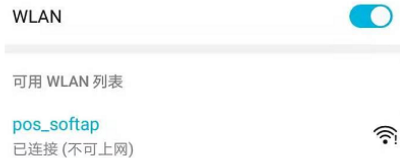
图 1: 连接 ESP32 AP
