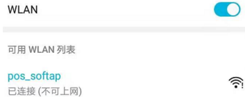
图 1: 连接 ESP32-C2 AP
