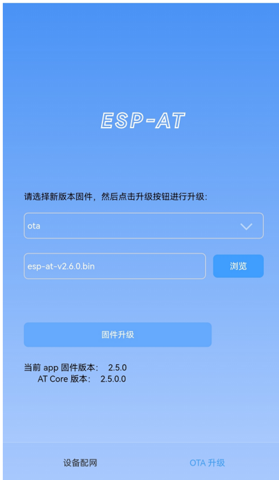
图 8: 选择待发送的新版固件
