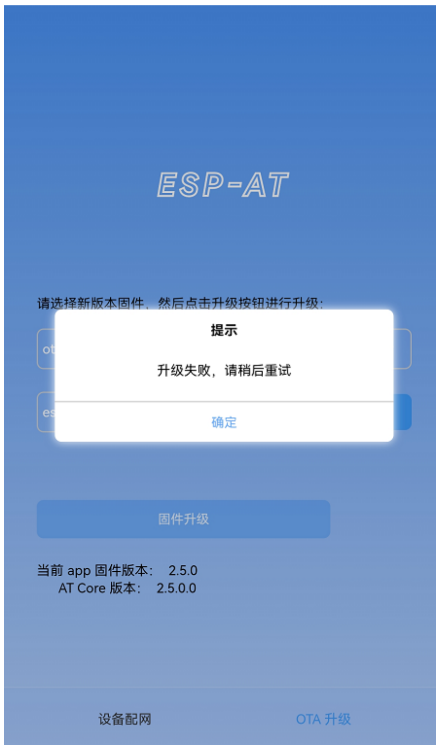
图 10: 新版固件发送失败
