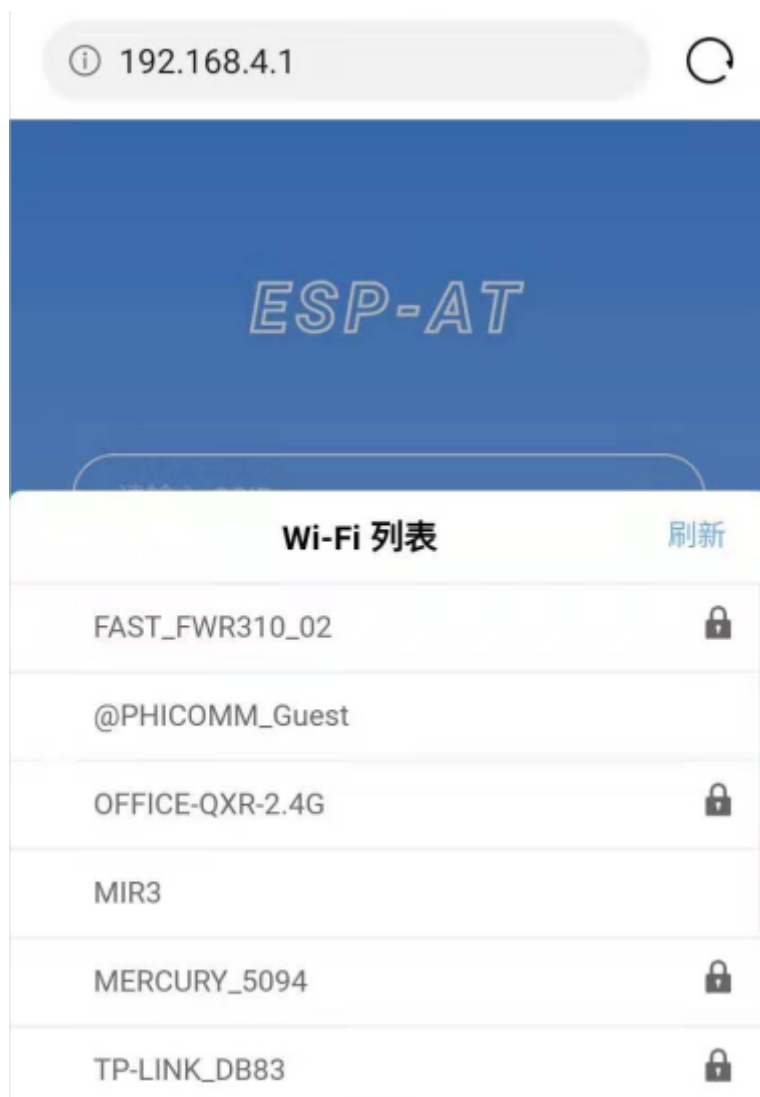
图 3: 浏览器获取 Wi-Fi AP 列表示意图
