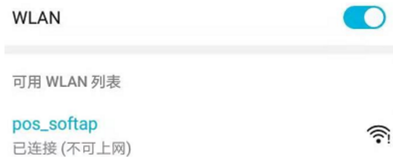
图 1: 连接 ESP32-C6 AP
