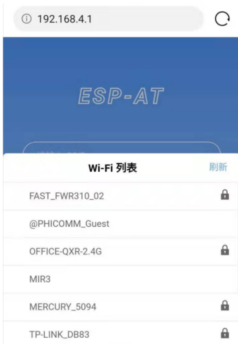
图 3: 浏览器获取 Wi-Fi AP 列表示意图
