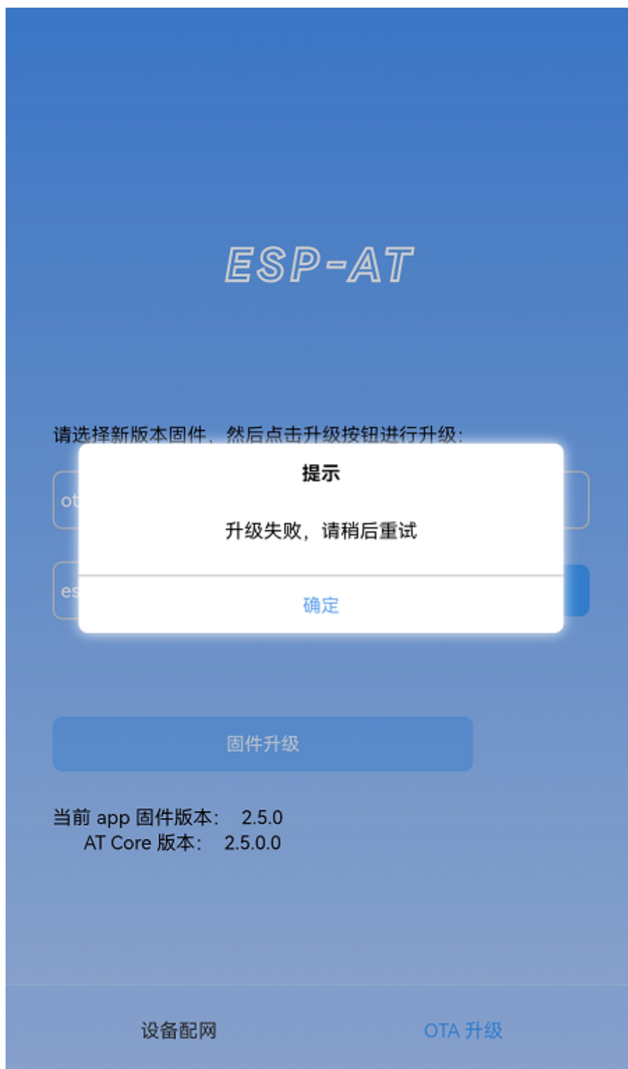
图 10: 新版固件发送失败
