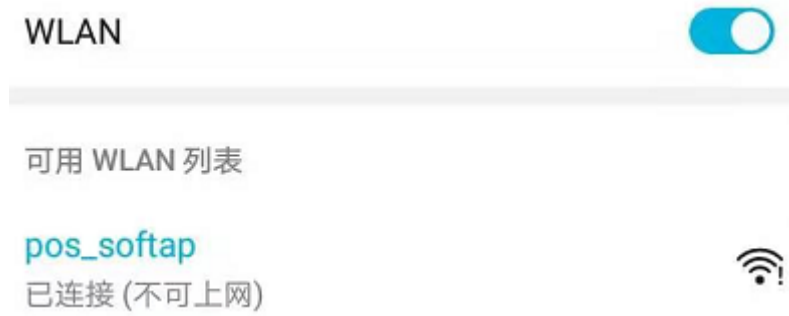
图 1: 连接 ESP32-C3 AP
