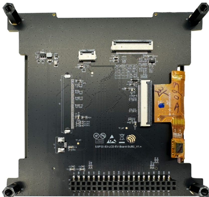
图 24: ESP32-S3-LCD-EV-Board-SUB2 - 反面 (点击放大)
