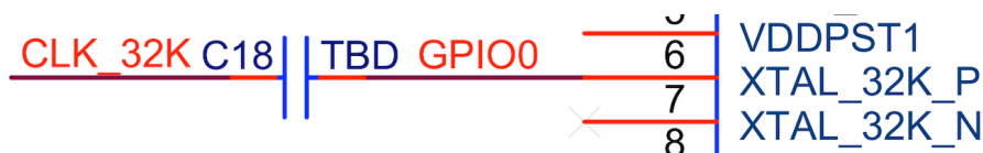
图 9: ESP32-C6 外部激励信号电路图
