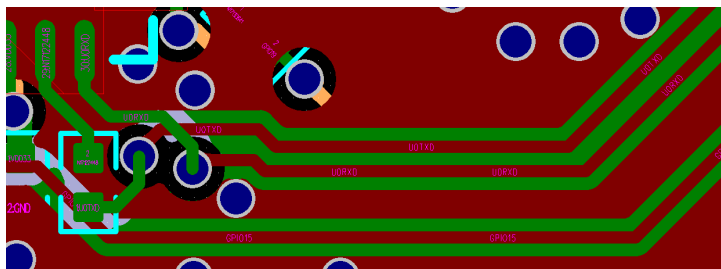
图 12: ESP32-C6 系列芯片 UART 版图设计
