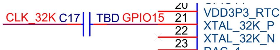
图 9: ESP32-S2 外部激励信号电路图
