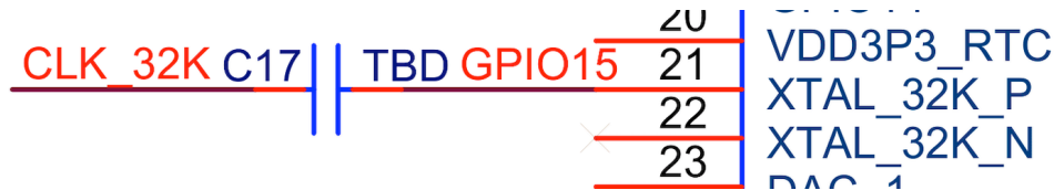
图 9: ESP32-S3 外部激励信号电路图
