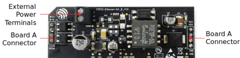
图 30: ESP32-Ethernet-Kit - PoE 子板 (B 板) 布局 (点击放大)
