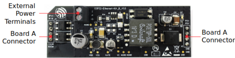
图 20: ESP32-Ethernet-Kit - PoE 子板 (B 板) 布局 (点击放大)
