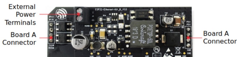
图 30: ESP32-Ethernet-Kit - PoE 子板 (B 板) 布局 (点击放大)
