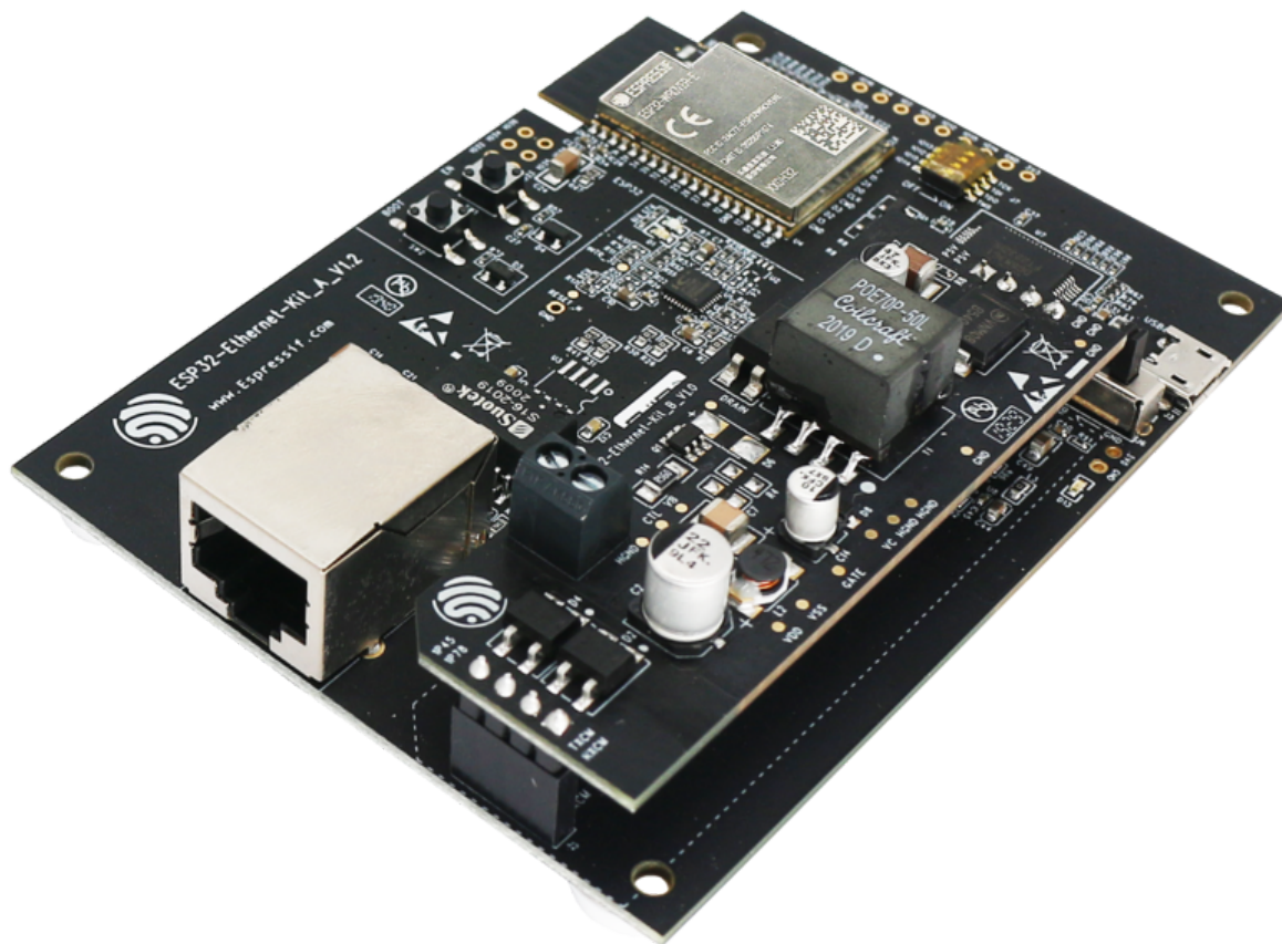
图 20: ESP32-Ethernet-Kit V1.2 概图 (点击放大)
