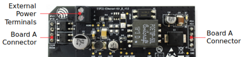
图 30: ESP32-Ethernet-Kit - PoE 子板 (B 板) 布局 (点击放大)
