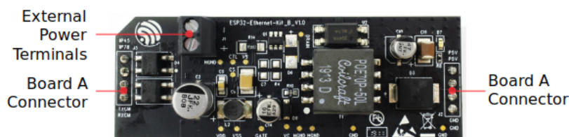
图 30: ESP32-Ethernet-Kit - PoE 子板 (B 板) 布局 (点击放大)
