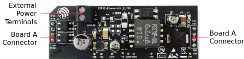
图 34: ESP32-Ethernet-Kit - PoE 子板 (B 板) 布局 (点击放大)
