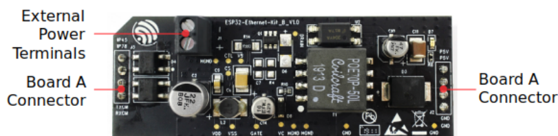
图 31: ESP32-Ethernet-Kit - PoE 子板 (B 板) 布局 (点击放大)
