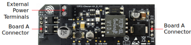
图 19: ESP32-Ethernet-Kit - PoE 子板 (B 板) 布局 (点击放大)
