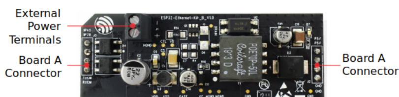
图 19: ESP32-Ethernet-Kit - PoE 子板 (B 板) 布局 (点击放大)
