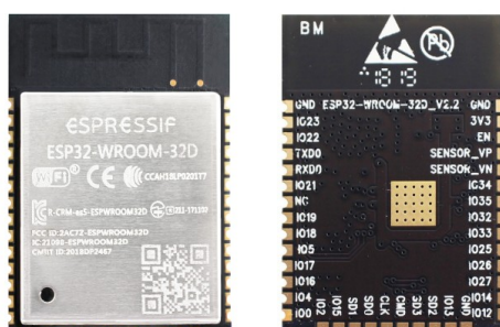
图 2: ESP32-WROOM-32D 模组 (正反面图)
