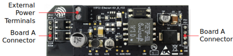
图 30: ESP32-Ethernet-Kit - PoE 子板 (B 板) 布局 (点击放大)
