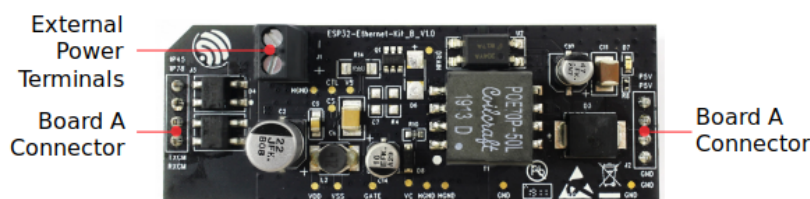
图 20: ESP32-Ethernet-Kit - PoE 子板 (B 板) 布局 (点击放大)
