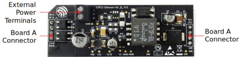
图 26: ESP32-Ethernet-Kit - PoE 子板 (B 板) 布局 (点击放大)
