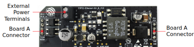
图 26: ESP32-Ethernet-Kit - PoE 子板 (B 板) 布局 (点击放大)
