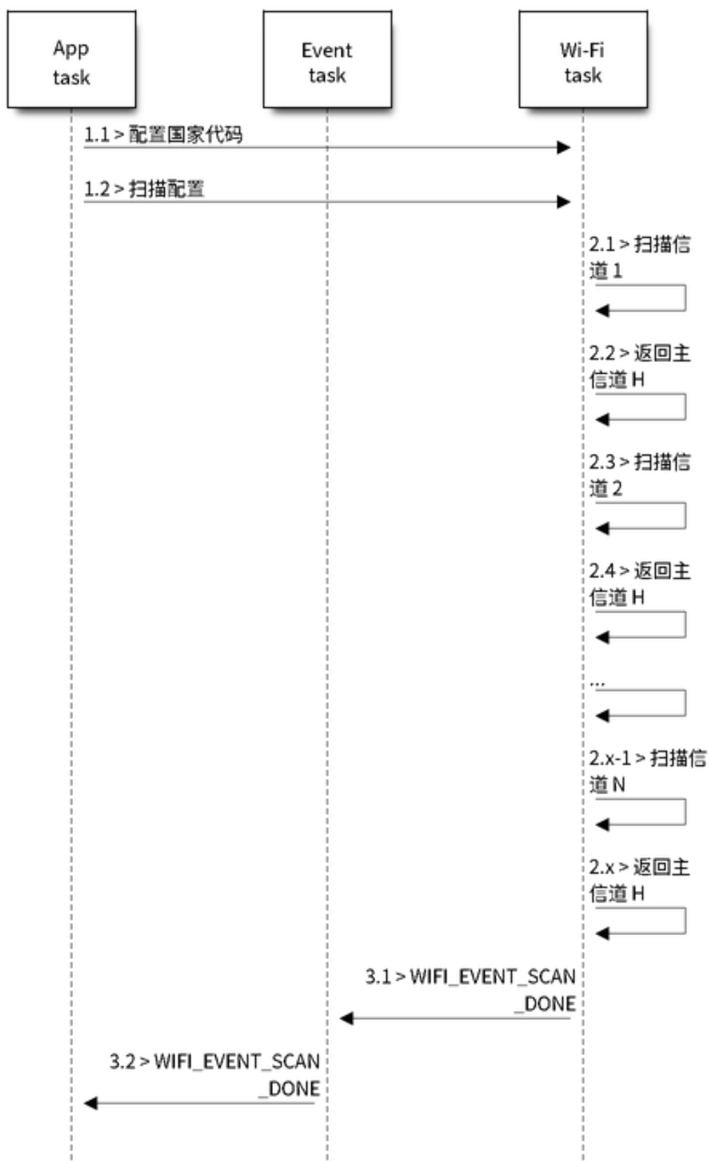
图 54: 所有 Wi-Fi 信道的后端扫描
