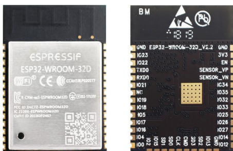
图 2: ESP32-WROOM-32D 模组 (正反面图)
