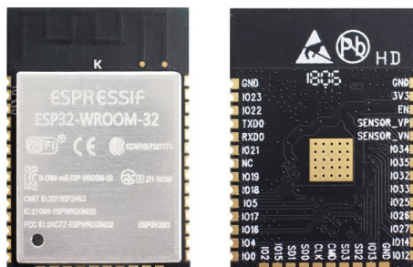
图 1: ESP32-WROOM-32 模组 (正反面图)
