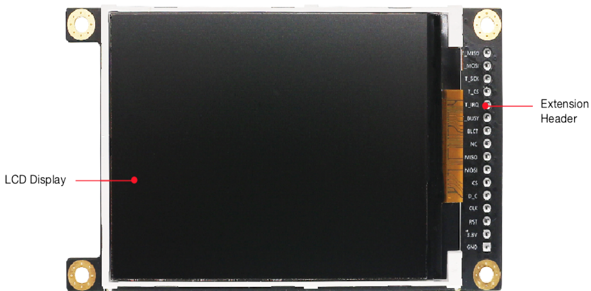
图 36: ESP-LyraP-LCD32 - 正面 (点击放大)
