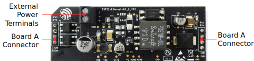
图 30: ESP32-Ethernet-Kit - PoE 子板 (B 板) 布局 (点击放大)
