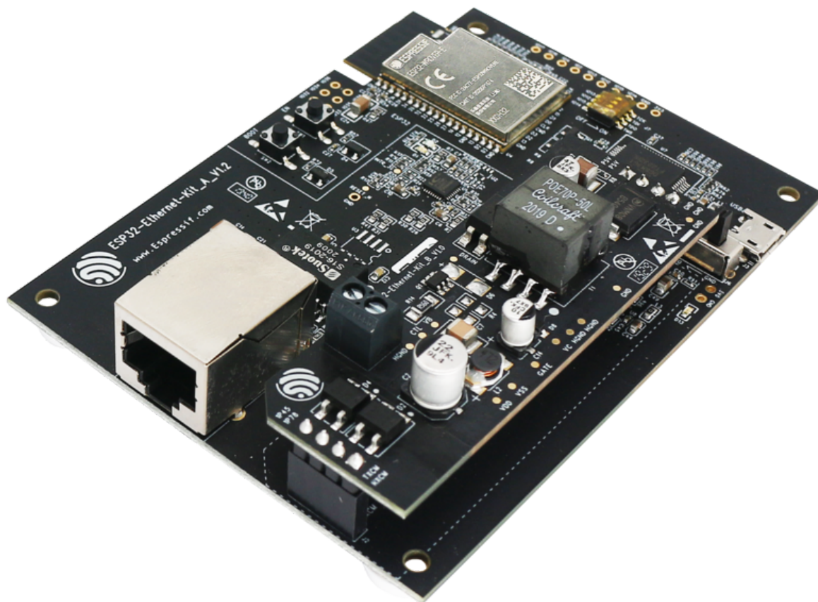
图 20: ESP32-Ethernet-Kit V1.2 概图 (点击放大)
