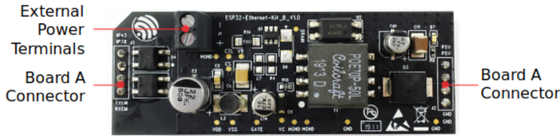
图 25: ESP32-Ethernet-Kit - PoE 子板 (B 板) 布局 (点击放大)
