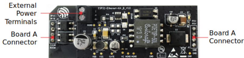
图 35: ESP32-Ethernet-Kit - PoE 子板 (B 板) 布局 (点击放大)
