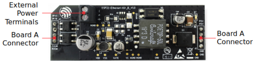
图 25: ESP32-Ethernet-Kit - PoE 子板 (B 板) 布局 (点击放大)
