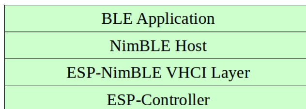
图 1: ESP NimBLE Stack
