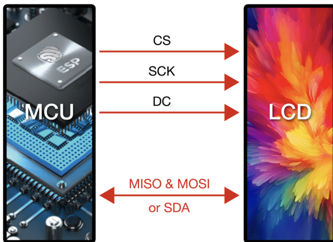
图 9: SPI 接口典型连接示意图
