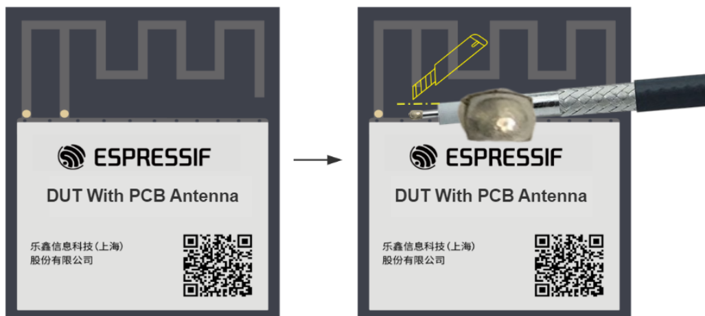
图 15: 带有板载 PCB 天线的模组焊接射频连接线示意图
