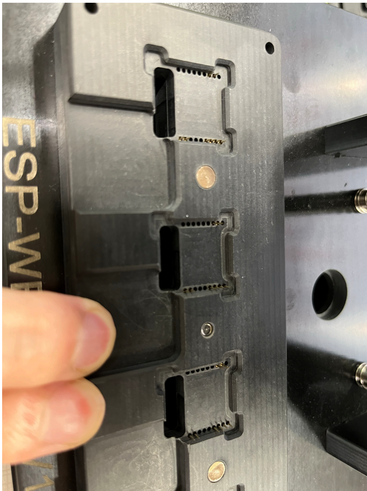
图 59: 探针状态示意图（手柄按下）
