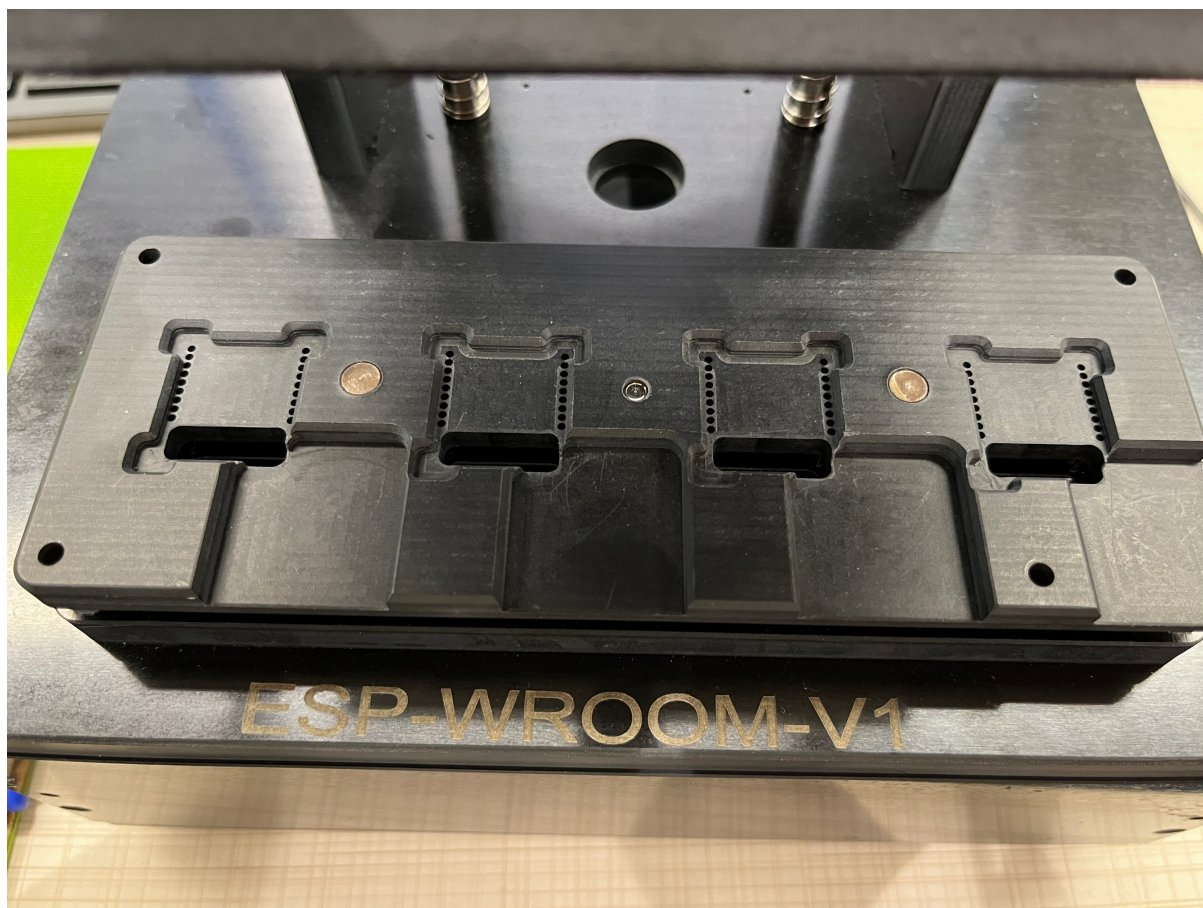
图 60: 探针状态示意图（手柄抬起）
