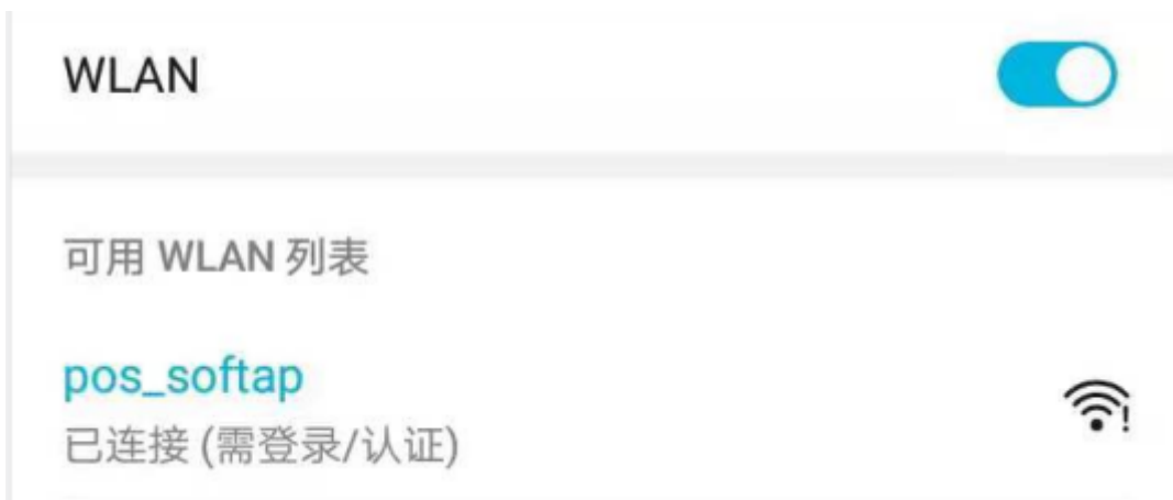
图 21: 连接打开 Captive Portal 功能的 AP
