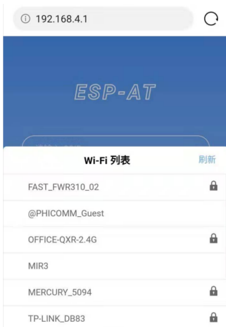
图 3: 浏览器获取 Wi-Fi AP 列表示意图
